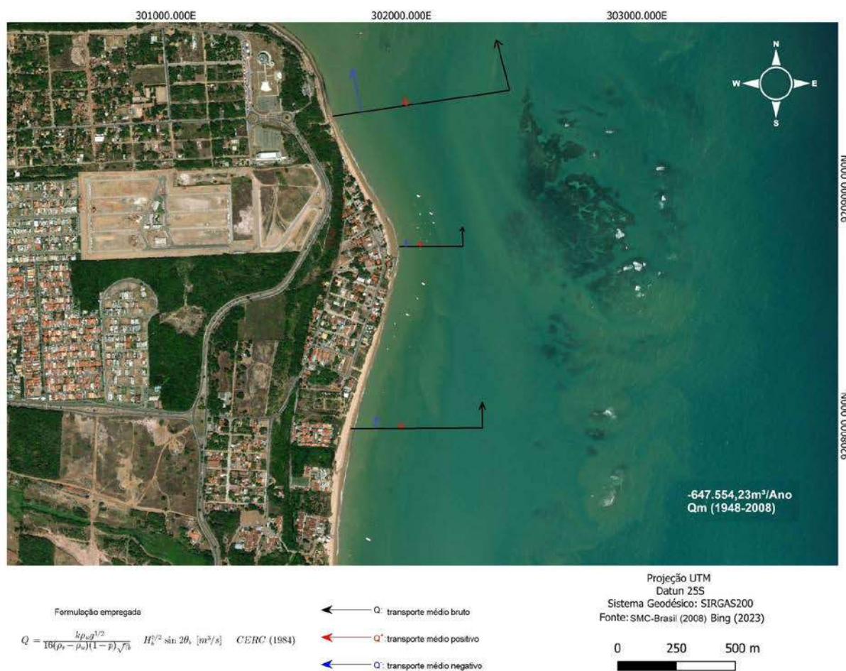
Figura 20 – Estimativa de transporte de sedimentos para a área do projeto. Nota: a seta preta indica a tendência do fluxo de energia no sentido norte. A seta vermelha corresponde ao fluxo no sentido norte-sul e a seta azul o fluxo no sentido sul-norte.
