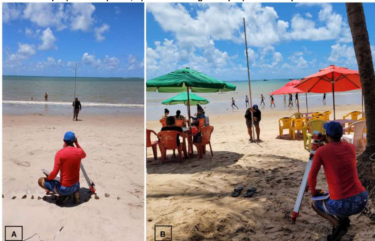
Figura 14 – Levantamento topográfico do dia 29 de março de 2025. A) Perfil morfológico da porção sul do pontal; B) Perfil morfológico da porção norte do pontal.
